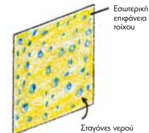
Επιφανειακή υγραποίηση υδρατμών (ίδρωμα τοίχων)
